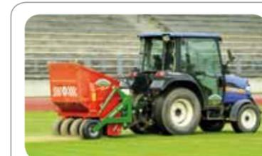
pro m<sup>2</sup> schafft bereits ein Arbeitsgang eine gute Belüftung der unteren Wurzelzone. Besanden: Sand macht eben, durchlässig und magert Feinteile und Rasenfilz ab. Die Sandmenge sollte etwa 20 bis 30t betragen. Verwendet wird ein gewaschener Sand der Körnung 0-2 mm. Die gleichmäßige Ausbringung erfolgt am besten mit dem speziellen Besandungsgerät Portax 3000.
