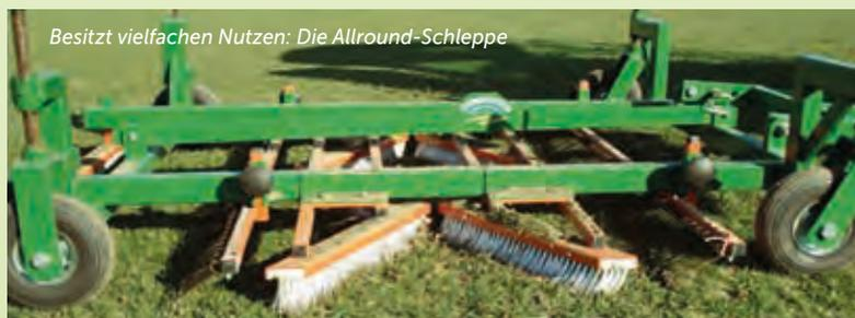
Bodenoberfläche entfernt. Wasser, Luft und Nährstoffe dringen wieder leichter in den Boden ein. Die variablen Größen der Schleppen und die sehr gute Eignung auch für Tennenplätze und für Kunststoffrasen (Allround-Schleppe) machen sie zum unverzichtbaren Gerät für jede Sportanlage.
